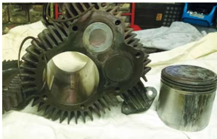
Zylinder und Kolben nach dem zweiten Schaden
