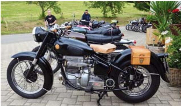
▲ Knuffig: Sundbeam mit längs eingebautem 2-Zylinder
