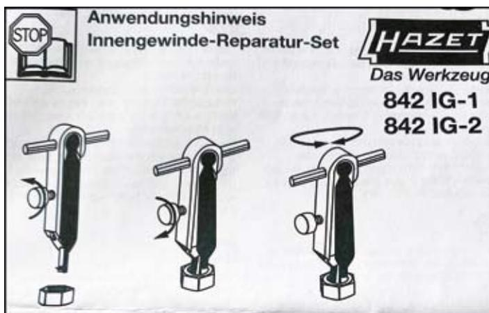
das Werkzeug entgegen dem Uhrzeigersinn um die Schraube und schneidet dadurch mit den zwei Messern das beschädigte Gewinde nach. Je nach dem muss man den Vorgang wiederholen, etwas schmieren nicht vergessen.
