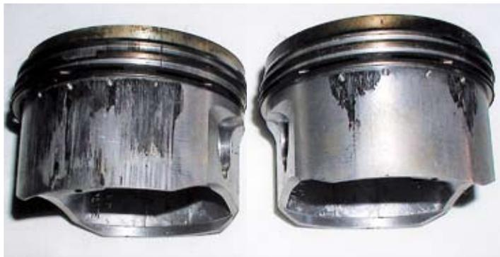
Die beiden Kolben nach dem „Klemmer“
