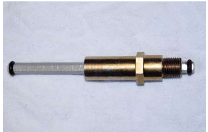
Kein Präzisionsteil, der „OT-Finder“. Zur Not kann auch ein Schraubenzieher in der Zündkerzenöffnung ein ähnliches Ergebnis bringen
