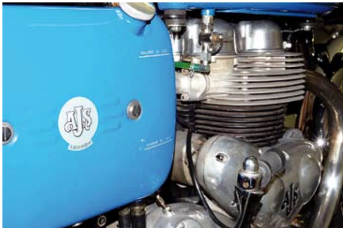
Gut sichtbar die einzelnen Zylinderköpfe und die gut zugänglichen Ventildeckel
