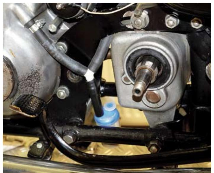
Zwischen Motor und Getriebe der Ölabscheider (Petromax)
