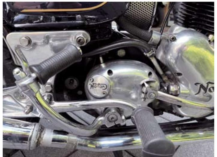
von Quaife. Eine elektronische Lucas-Rita Zündung rundete die Motorüberholung ab. Der Kabelbaum wurde ebenfalls erneuert und alle überflüssigen Kabel entfernt, zusätzliche Massekabel verlegt. Einige Teile und Schrauben wurden durch V2A Teile ersetzt.
