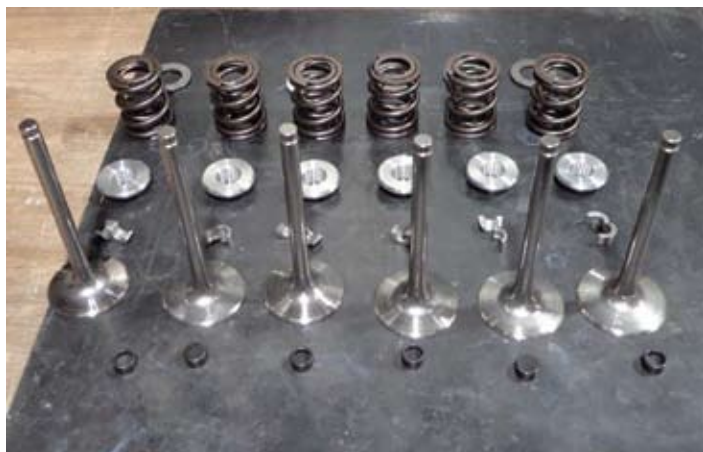
Die neuen Ventile für die BSA M24 Köpfe, Foto: Klaus. Jung
