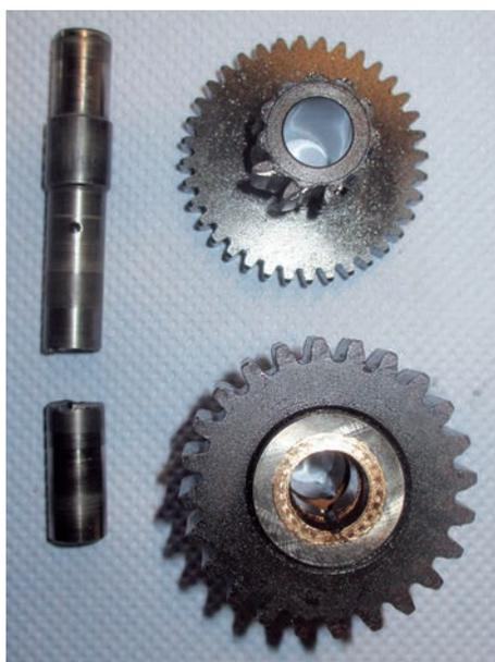
Gebrochene Welle, abgescherte Zähne
