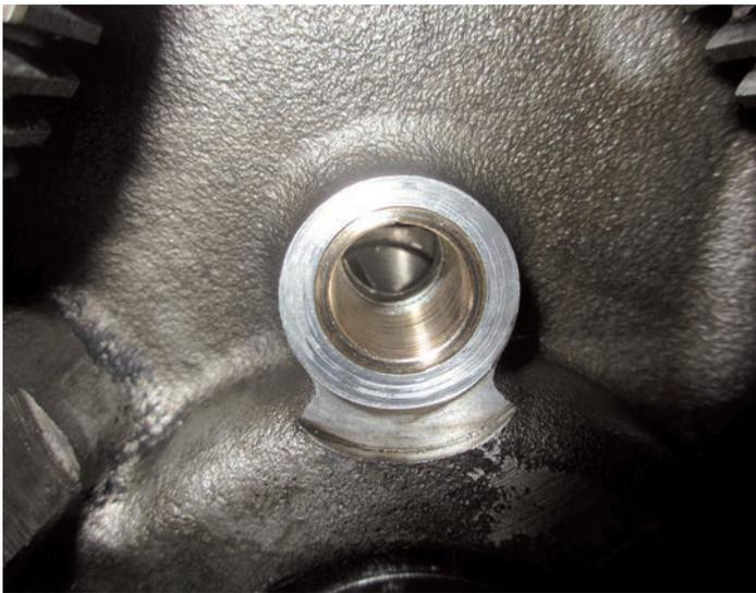
Neue Lagerbüchse montiert
