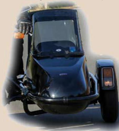
gen in Deutschland wird Sturz eingestellt damit die Maschine auf runder Fahrbahn geradesteht und es stabilisiert in Linkskurven. Beim Linksseitenwagen in Deutschland muss ich somit negativen Sturz einstellen um den gleichen Effekt zu erreichen. Man denke zurück an den VW Käfer. Da stellte man für sportliche Ambitionen etwas mehr negativen Sturz ein damit er besser lag.
