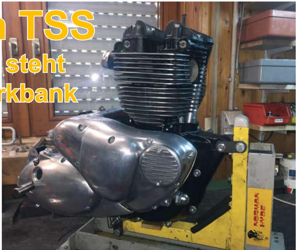
einzupassen. Ach ja, was ich fast vergessen habe: nur durch Zufall bin ich drauf gekommen das beide Zündkerzen Elektroden gar nicht in den Brennraum ragten, sondern ca. 4-5mm tiefer in der Bohrung. Sicher nicht im Sinne einer guten Verbrennung. Auf meiner Fräsmaschine konnte ich das relativ einfach korrigieren, gut das ich das noch gemerkt habe.
