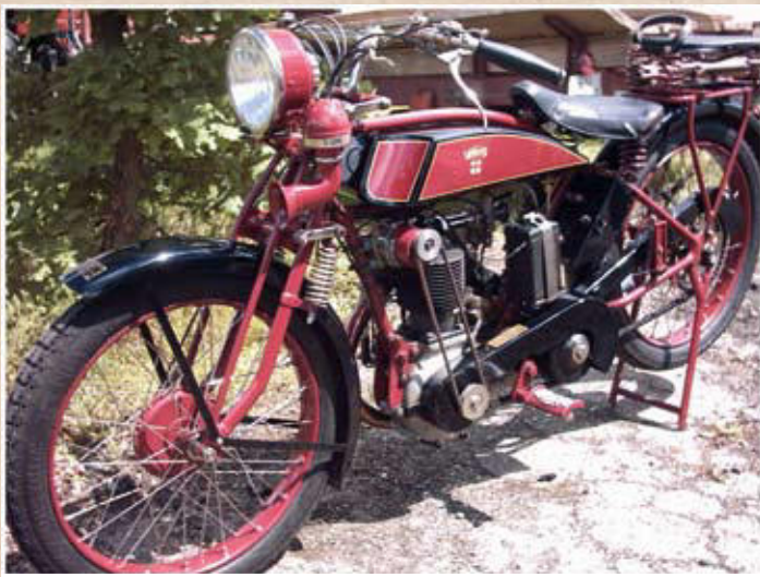
LUWE 500 ccm, Mod.27, mit wechselgesteuertem 13 PS MAG Motor
